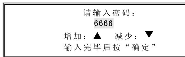
本系统只有一个密码，出厂初始密码为 6666。在密码输入界面内，按  $\blacktriangle$  键，可以增加或减少输入的密码数值，按另外两个方向键均可以使输入的密码数值变回 6666。按退出键，退回上一级菜单，按“确定”键，系统自动进行密码核对。若密码正确，即可自动进入下一级菜单；密码错误，将提示用户密码错误，三秒钟后将自动退回到上一级菜单。
